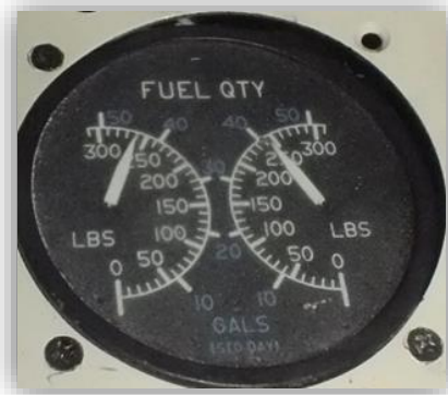
Indicador de combustible de la aeronave
